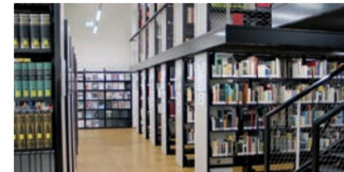
BR ist stabil und wirtschaftlich. Mehrstöckige Konstruktionen erfordern keine systemfremden Bühnenaufbauten. Die verstärkten Mittelpfosten tragen sicher die Bühnenkonstruktion der Regalstockwerke darüber. Referenz: Hochschule für Bildende Künste, Dresden.
