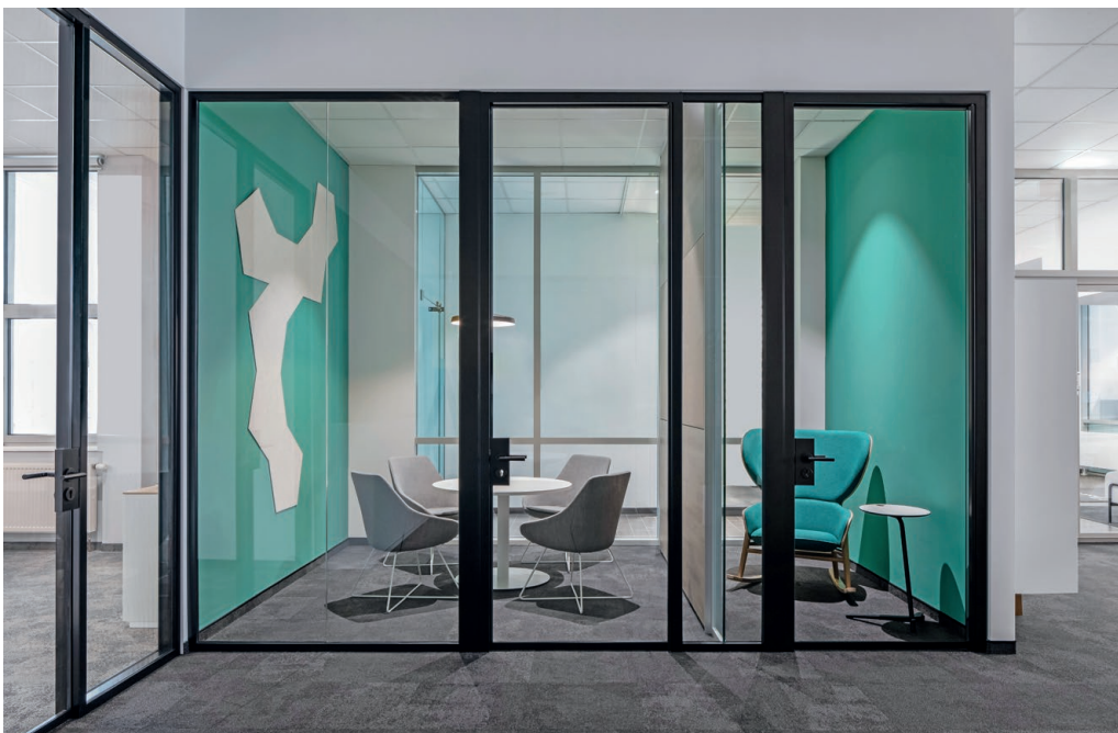
Einschalige Ganzglaswand mit Aluminiumprofilen in RAL 9011 (Graphitschwarz), raumhohe Drehtüren mit Zarge und Bandraster schlossseitig
