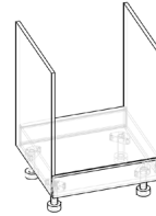
Unterschrank für E-Herd KKU6090H Höhe: 725 mm Breite: 600 mm
