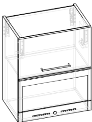
Oberschrank 750 für Mikrowelle KKO6075M Höhe: 750 mm Breite: 600 mm
