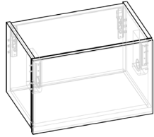
Oberschrank 375 / Klappe KKO6037K Höhe: 375 mm Breite(n): 350-900 mm mit 23 mm Griffüberschlag
