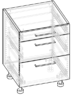
Unterschrank KKU6090L3 Höhe: 725 mm Breite(n): 300-900 mm mit 3 Läden
