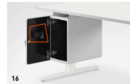
15 | ANBINDUNG AN TISCHPLATTE Über Konsolenadaption lässt sich die Box links oder rechts an einer 25-mm-Platte anbringen. Das Adaptionset wird mitgeliefert. Die Box ist um 180° drehbar und kann damit auf beiden Seiten montiert werden.
